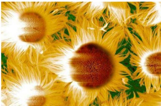
二氧化硅纳米线的扫描电镜照片
